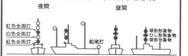
図-8 浚渫船「海翔丸」の灯火及び形象物
