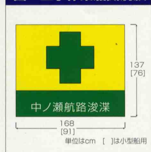
図 工事作業船識別旗
