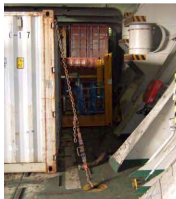
チェーンによるコンテナの固縛
