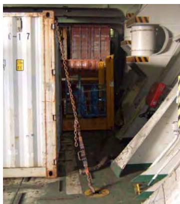
チェーンによるコンテナの固縛
