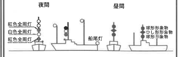
図-8 浚渫船「海翔丸」の灯火及び形象物
